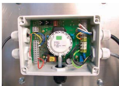
Вентиляторы серии DVC оснащены встроенной системой управления.
