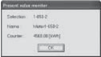
Подсчет импульсов (например, от счетчика электроэнергии)
