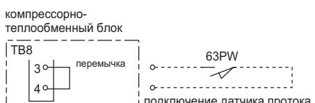
При подключении датчика протока удалите перемычку между клеммами 3 и 4 колодки TB8.
